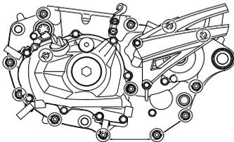
**N.B.** Desserrer chaque boulon d'1/4 de tour à la fois puis, lorsque tous les boulons sont desserrés, les déposer.
