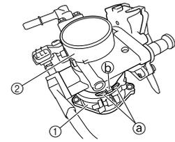
2. Monter le cache résistant à l'eau "1" sur le boîtier d'injection.
