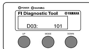
2. Sélectionner le mode de diagnostic des pannes "DIAG" en appuyant sur le bouton "UP".
