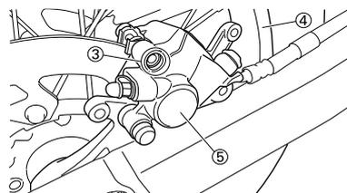
d. Déposer la goupille de plaquette "6" et les plaquettes de frein "7".
