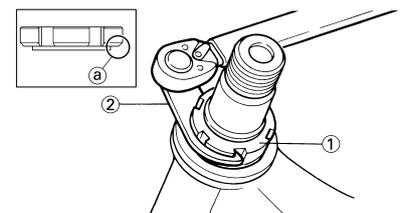
5. Contrôler la colonne de direction en la tournant d'une butée à l'autre. S'il y a la moindre gêne, démonter la colonne de direction et contrôler les paliers de la direction.
