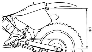
3. Desserrer le contre-écrou "1" et effectuer le réglage en tournant le dispositif de réglage "2" de manière à atteindre la valeur standard, obtenue en soustrayant la longueur "b" de la longueur "a".
